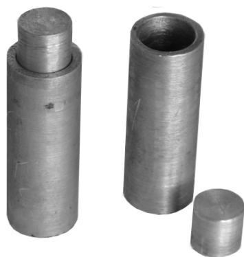
Рис. 5. Контейнер для винтовой экструзии порошковых заготовок
