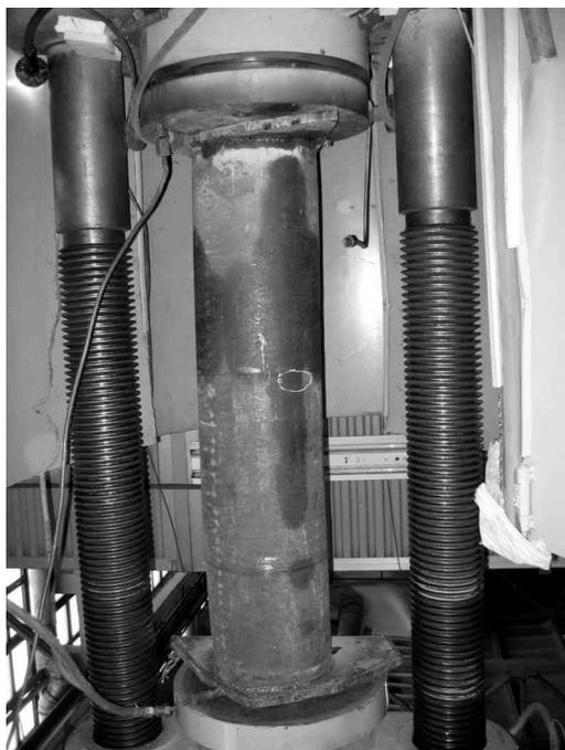
Рис. 1. Стенд для испытаний на внутреннее гидравлическое давление
