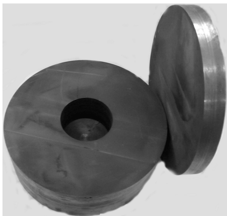
Рис. 7. Заготовки барабана ГТД диаметром 570 mm из сплава ЭП741НП после жидкофазного спекания
