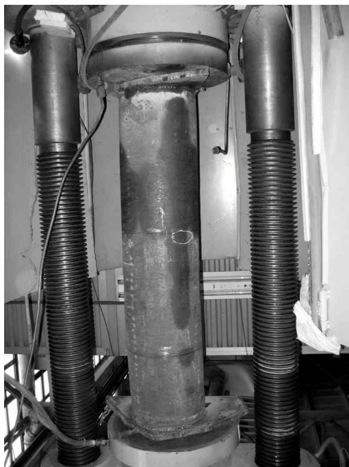
Рис. 1. Стенд для испытаний на внутреннее гидравлическое давление
