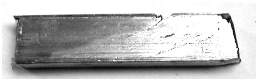
Рис. 6. Заготовка после 20 циклов РКУП по маршруту Вс
