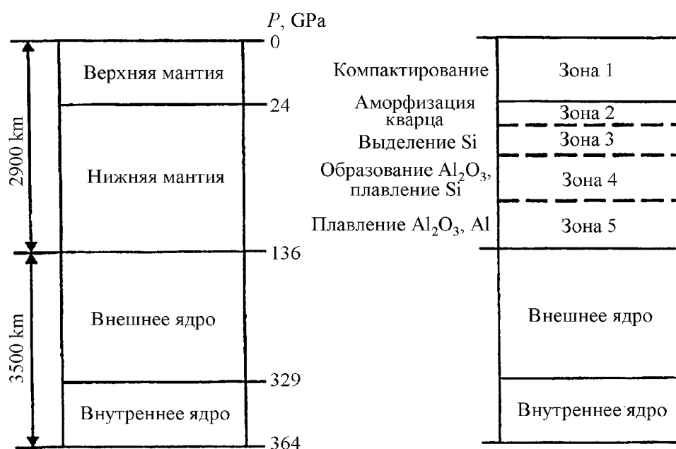
Рис. 4. Сравнение полученных данных о фазовом составе различных слоев компакта после ударного нагружения с положением слоев в земном шаре
