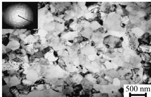
Рис. 2. Микроструктура сплава \text{Ti}_{49.8}\text{Ni}_{50.2} после проведения 8 проходов РКУП при 450^\circ\text{C} [30]
