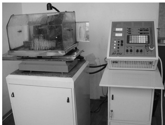
Рис. 1. Станок для электроэрозионной обработки модели ZAPbp-95d
